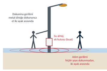
ŞEKİL 8. Dokunma ve adım gerilimi.
